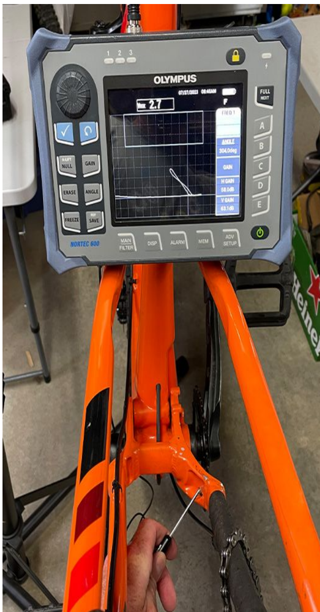
Skenování prasklého místa na rámu jízdního kola vířivými proudy pomocí detektoru vad na bázi vířivých proudů NORTEC 600.
